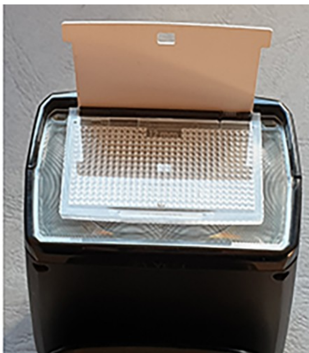
Fig 1.3 Cabezal de flash con pestaña difusora y tarjeta reflectora extraídas
