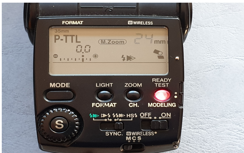
Fig 1.5 Flash en modo TTL. En este caso concreto es P-TTL ya que es un flash dedicado para Pentax; cada marca tiene sus propios modos y nombres como el I-TTL, E-TTL, etc.
